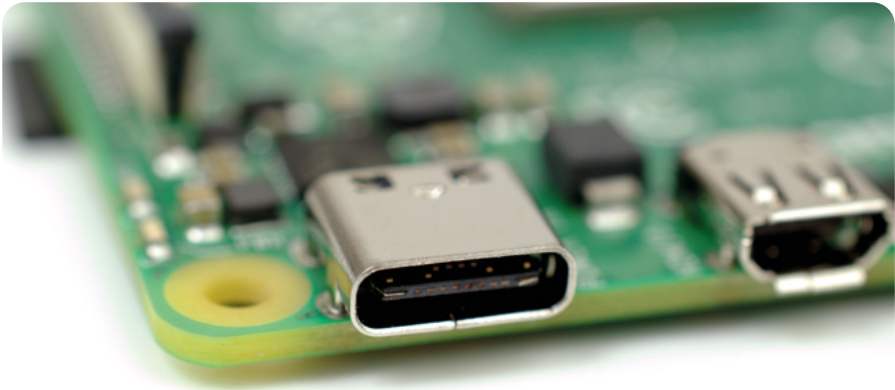
▲ Figura 1-11: la porta di alimentazione USB di tipo C di Raspberry Pi
