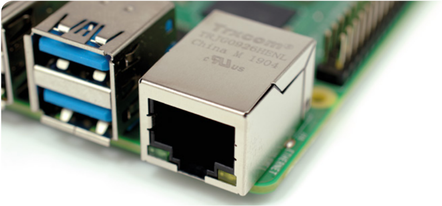
▲ Figura 1-7: la porta Ethernet di Raspberry Pi
